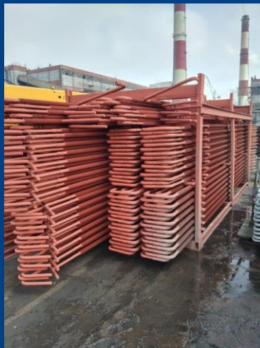
Пакеты змеевиков водяного экономайзера I и II ступени для к/а БКЗ-420-140
